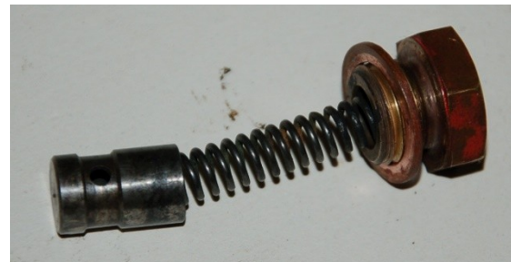
Fig 3 Overdrukventiel B16 met veer, koperen pakking en bout (let op gaatje in ventiel)
